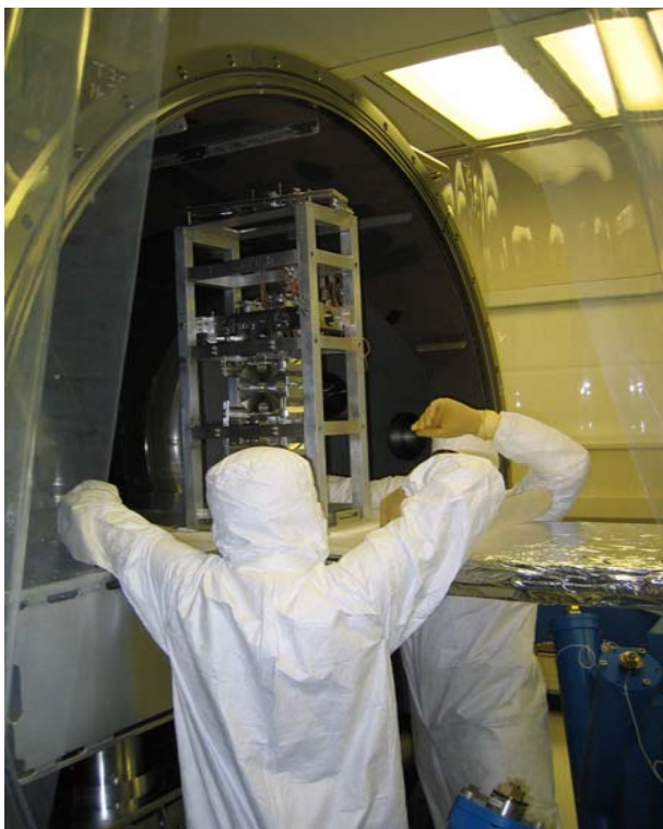
Triple pendulum suspension testing at MIT facility
