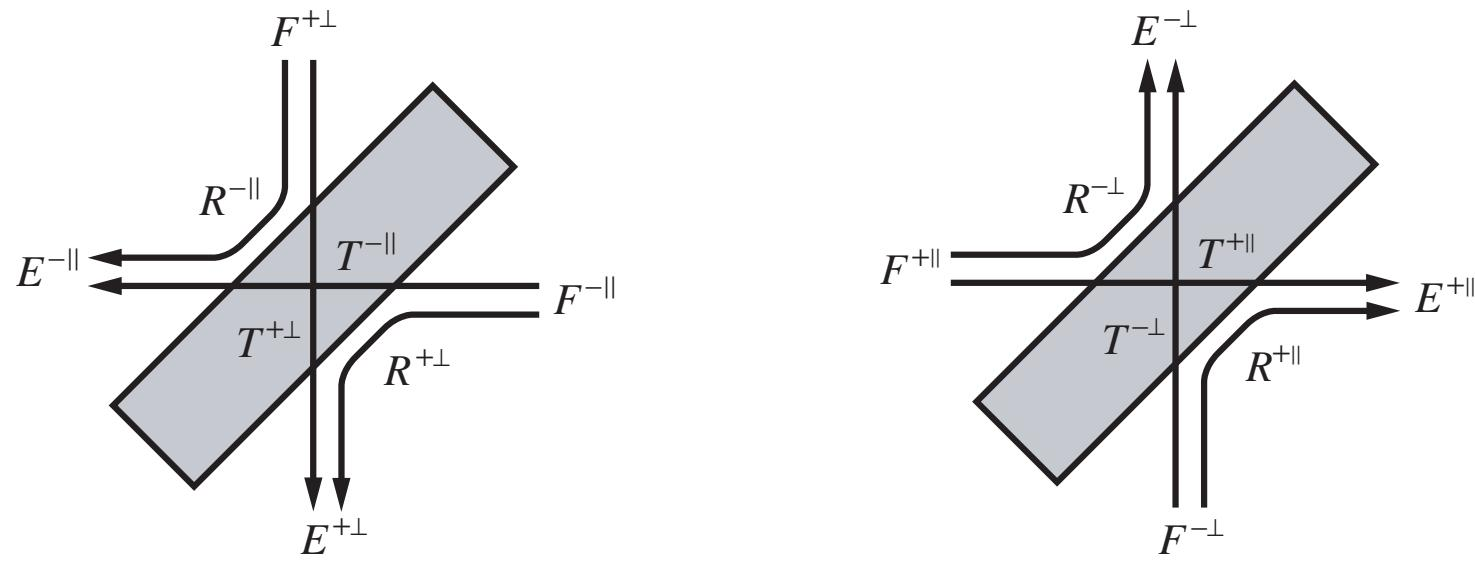
$$\begin{bmatrix} E^{-\parallel} \\ E^{+\perp} \\ E^{+\parallel} \\ E^{-\perp} \end{bmatrix} = \begin{bmatrix} T^{-\parallel} & R^{-\parallel} & 0 & 0 \\ R^{+\perp} & T^{+\perp} & 0 & 0 \\ 0 & 0 & T^{+\parallel} & R^{+\parallel} \\ 0 & 0 & R^{-\perp} & T^{-\perp} \end{bmatrix} \begin{bmatrix} F^{-\parallel} \\ F^{+\perp} \\ F^{+\parallel} \\ F^{-\perp} \end{bmatrix}$$
