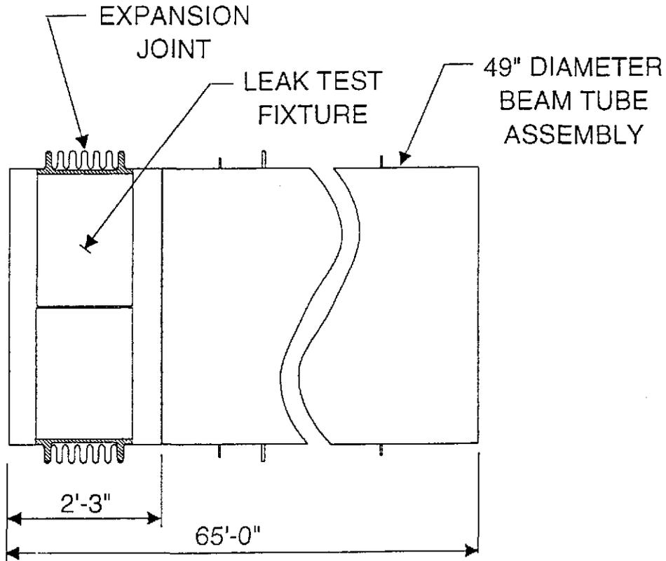
FIGURE 3 - FIXTURE FOR SUPPORTING EXPANSION JOINT
