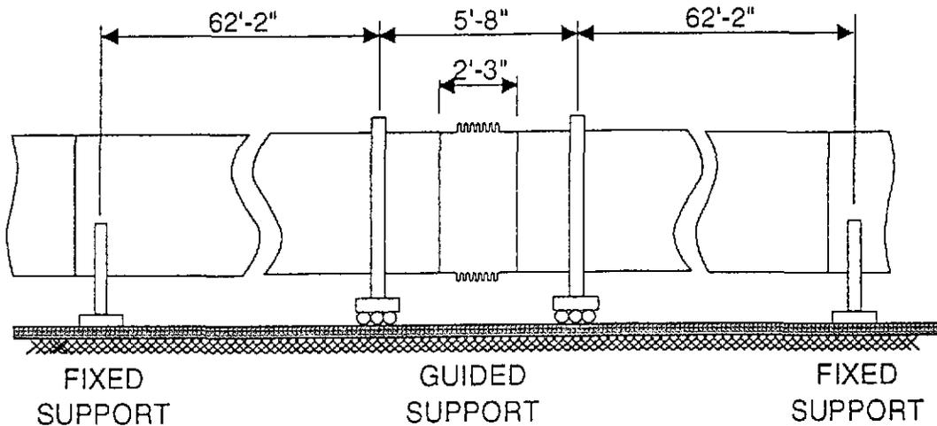
FIGURE 1 - CONFIGURATION OF BEAM TUBE AND EXPANSION JOINT
